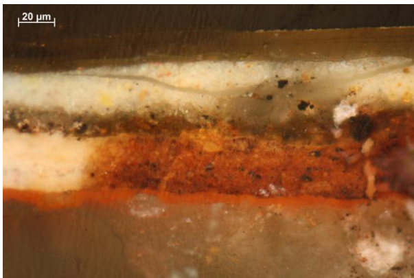
↑ A rétegek kén-hidrogén gáz hatására Polarizációs mikroszkópos felvétel, 50x objektív
