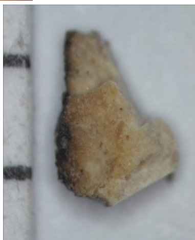
↑ Sztereomikroszkópos felvételek a darabmintáról a festett felszín és az alapozó felől, körmegvilágítással, 4x és 7,5x objektív. Az alapozó felett vörös színű réteg és aranszínű fólia látható, majd fehér festés és a sötét felszíni réteg. A minta oldala szennyezett.
