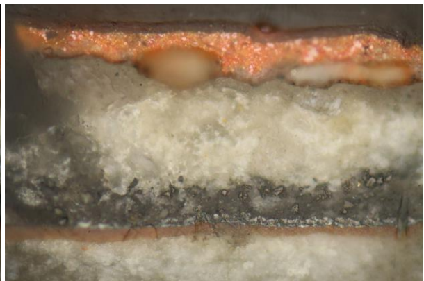
↑ Polarizációs mikroszkópos felvétel ráeső fényben, keresztezett és párhuzamos analizátor-állásnál, 50x objektív A vörös réteg alatti sáv viaszos anyagot tartalmazhat, az UV sugárforrás hője hatására megolvadt és cseppekben kiült a minta felszínére.
